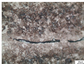
图八 HCWK072矛刃部金相组织照片
