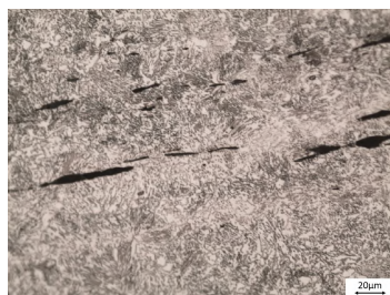
图六 HCWK076刀刃部金相组织照片
