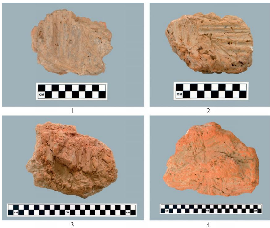
图一八 凤雏甲组基址屋面墼壁残块所见苇束印痕 1—4.76QFF1 : ST242、ST204、ST192、ST118
