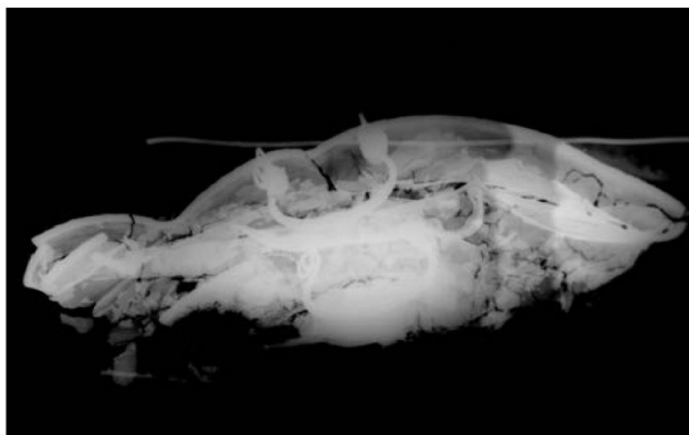
图3 M3-1：25 X射线探伤片 (X射线探伤条件: 130kV/3mA/1min/80cm)
