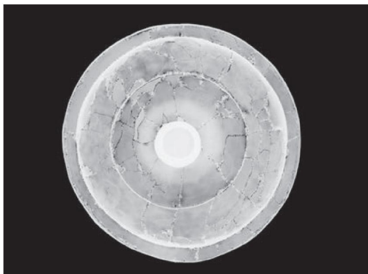
图 22 M3-1 : 177 X 射线探伤片 (X射线探伤条件: 120kV/3mA/1min/80cm)
