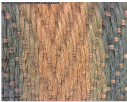
图六 M7:9山形斜纹绫组织结构
