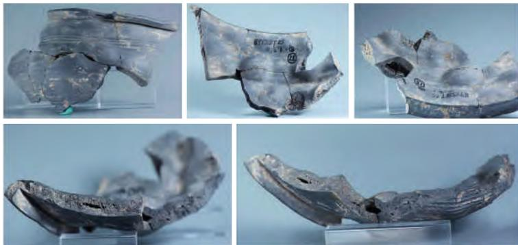
图五 出现蜂窝膨胀、鼓包和软化变形的残次陶片 T25G1:028
