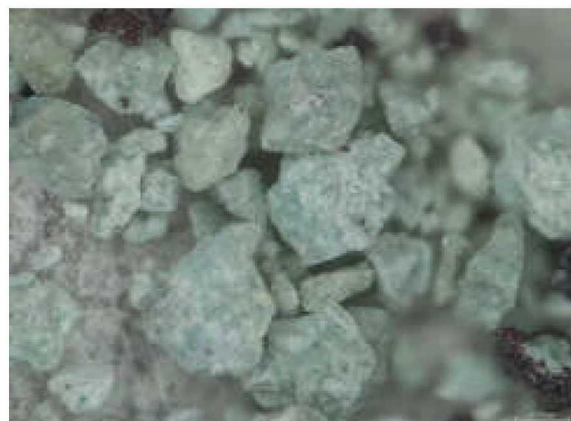
图五七 样品 M18:9-3, Cu: 10.39%, Sn: 89.61%
