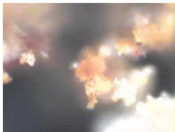
图五二 甌(M18:8-1)第2处黄色锈蚀中黄色颗粒微观形态及拉曼光谱图 ⑤ (分析结果: \beta - \text{PbO} (密陀僧))
