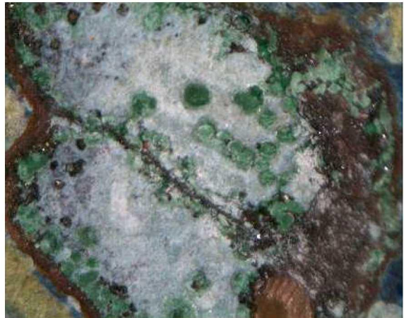
图四〇 除锈部位出现绿色星点锈
