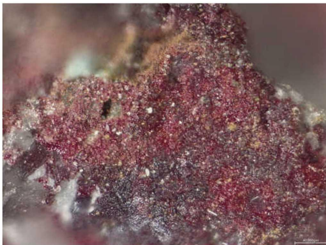
图四九 样品 M18:8-2 单晶衍射分析红色锈蚀为赤铜矿( \text{Cu}_2\text{O} )
