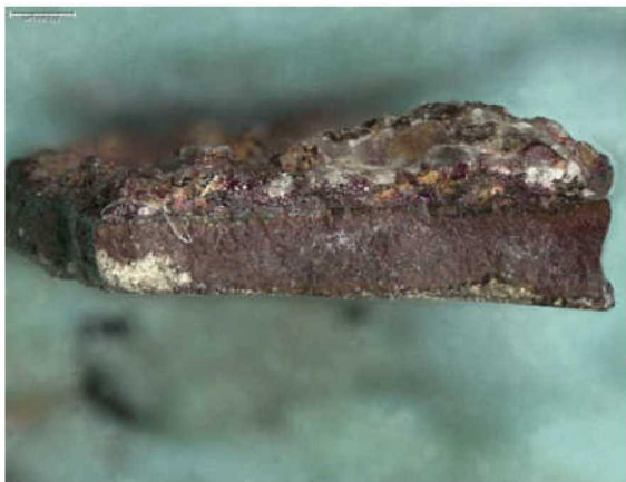
图四七 残片断面,表面上红锈夹有黄、白、棕等
