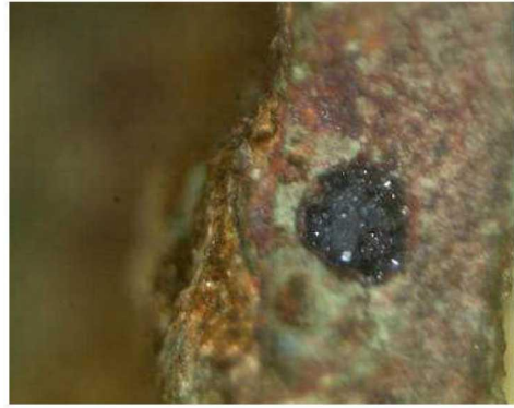
图三五 断面孔隙内的黑色闪亮颗粒
