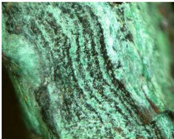
图一三 膨胀严重、多重夹层
