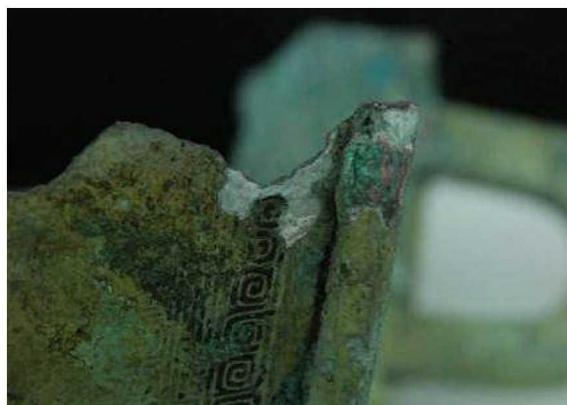
图五 器壁下的粉状夹层锈
