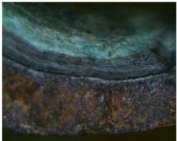
图一六 锈蚀堆积层
