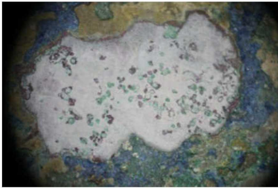
图三九 白色夹层上的绿色星点锈
