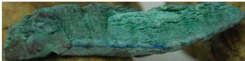
图一八 瘤状锈块的多重锈蚀层
