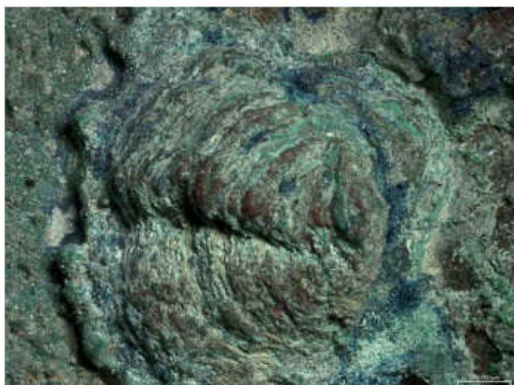
图一九 瘤状锈的层状堆积结构
