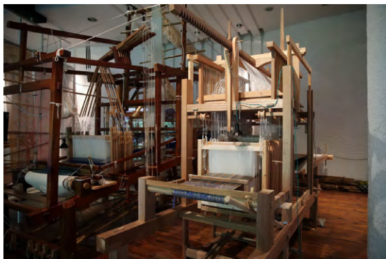
图一二 中国丝绸博物馆制“五星出东方利中国誅南羌四夷服單于降與天無極”锦的织机侧面,86片综框拥挤排列的状况
