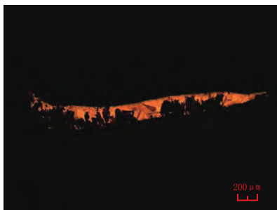
图八 金箔剖面侵蚀后(50倍)
