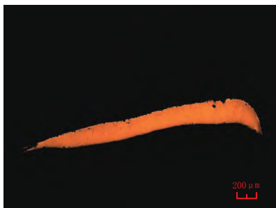
图七 金箔剖面侵蚀前
