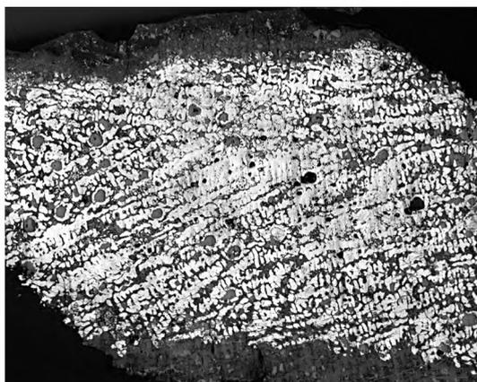
图七 TT-3 铜质部分金相组织图(x50)(未浸蚀)
