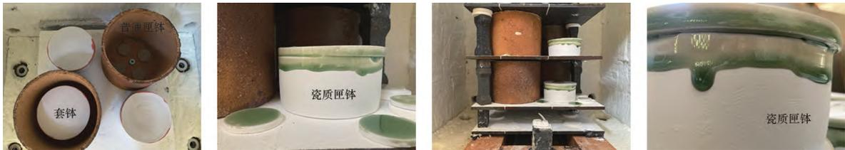
图 2 梭式燃气窑装烧
