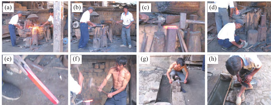
图 5 户撒刀夹钢工艺过程
