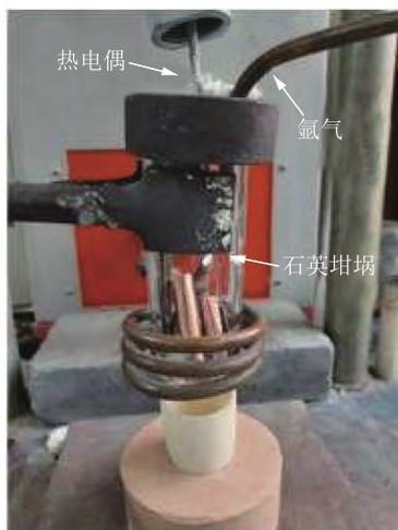
图 2 熔炼装置
