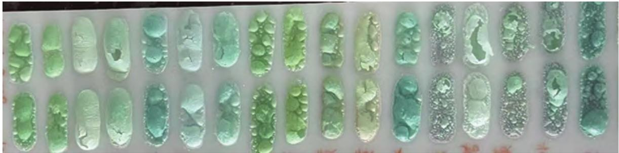
图3 由于前1 h 急躁升温导致不同色阶绿彩表面的起泡现象
