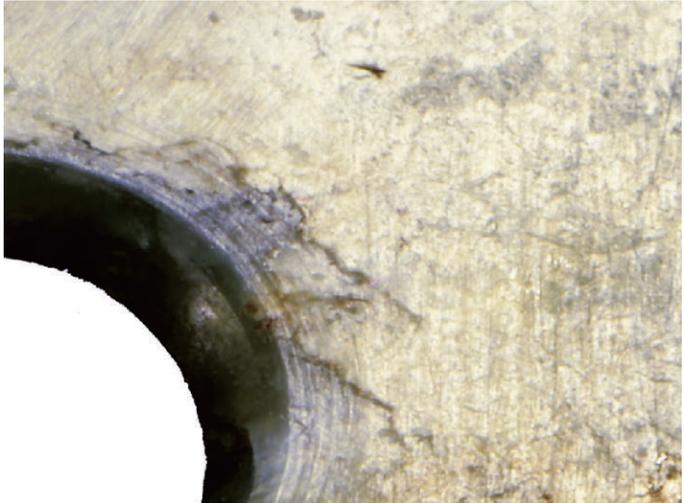
图五 中孔边缘旋转磨痕及肉身磨痕（1.175-6）
