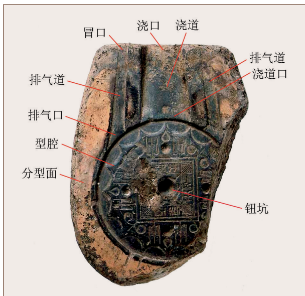
图四 齐故城出土镜背范结构示意图
