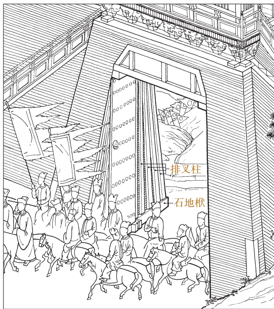
图二 城门石地袱与排叉柱示意图 （据萧照《中兴禎应图》局部摹绘，参见梁思成：《〈营造法式〉注释》第86页，生活·读书·新知三联书店，2013年）
